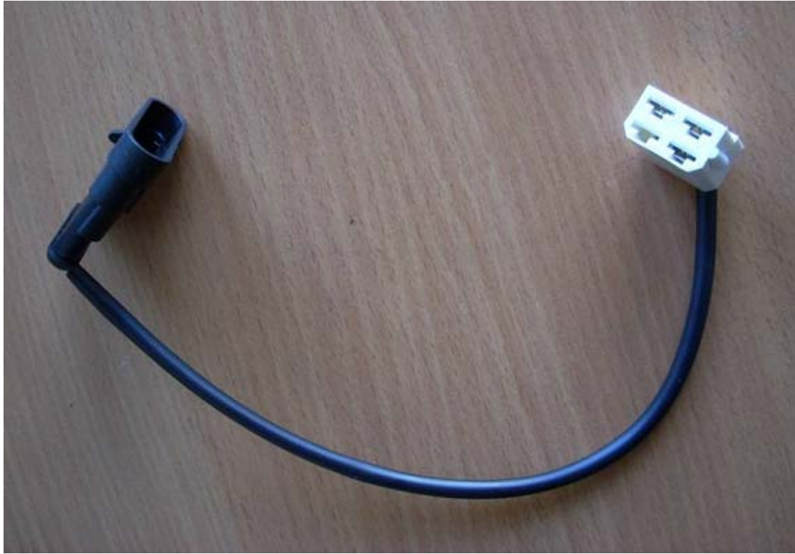
Переходной жгут (позиция 4, рис.1)
